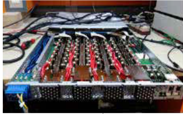
AC/DC Power Shelf ที่ทำให้กับ 19.org (19.2kW 50 fused 12V outputs)
